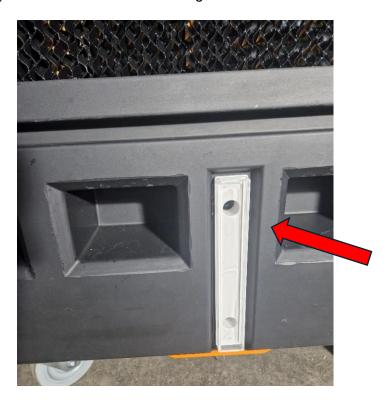
5. Bei Betrieb per Festwasseranschluss darauf achten, dass beim Festziehen des Außenseitigen Anschlusses, auch der Festwasserschwimmer (Innenseite) gegen gekontert wird. Der Festwasserschwimmer muss senkrecht nach unten zeigen, da sonst eine korrekte Abschaltung bei Erreichen des Maximalpegels nicht möglich ist. Aus Sicherheitsgründen empfehlen wir auch, die Zulaufleitungen nachts abzudrehen.
